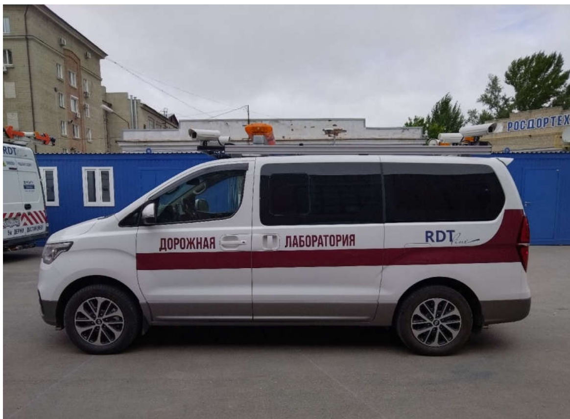
Рисунок 1.1 – Комплекс измерительный передвижной аэродромно-дорожной лаборатории КП-514 RDT Line
